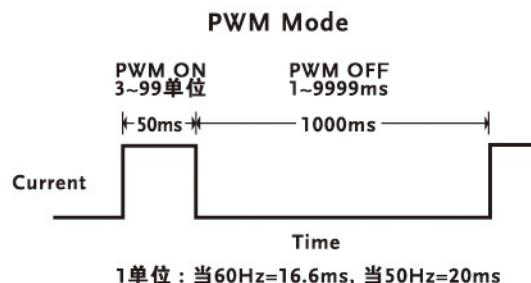
GOM-805 还提供了数种电流输出的驱动模式，以期符合更多样且正确的低电阻测量状况。例如不同材料的导体互相接触时，因各别导体对温度变化不同所产生的热电势，可用脉冲电流输出模式，来降低在低阻测量时的热电动势影响。或材料本身对温度变化相对敏感者，则可使用脉宽调制输出模式，减少因长时间大电流加载造成的阻值变化；直流 +/ 直流 - 电流输出模式，则适用于电感性组件的测量需求。
