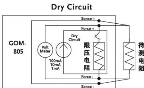
干电路 (Dry circuit)，就是将测试电压和电流限制到不能引起接触点产生物理或电学变化的电路，常见的应用是接触阻抗的测量。依据 MIL-STD-1344 的方法 3002-1~低信号准位接触电阻，测试时必须限制最大开路电压在 20mV( 含 ) 以下，而短路电流则为 100mA 或更低的情况，以避免组件两端的电压过高，破坏了接触点表面的氧化层或薄膜，进而破坏测量的有效性。GOM-805 提供 3 个档位 (500mΩ:100mA/5Ω:10mA/50Ω:1mA) 可将开路电压限制在 20mV，执行干电路测试。
