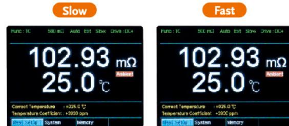
GOM-804/805 提供了 2 种测量速度—快速: 可达每秒 60 个读值/慢速: 每秒 10 个读值。不同于以往，用户必须在速度和显示分辨率间进行取舍，在 GOM-804/805 上，不管选择的速度为何，都会维持最高的分辨率；即读值分辨率不会因为速度的改变，而造成分辨率下降的情况。
